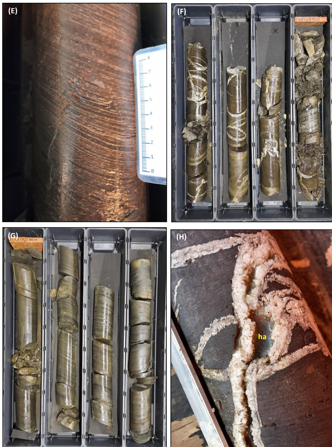
Fotografia 01 - (E) detalhe do S_0 , sublinhado pela intercalação milimétrica de argilito e calcário, típicos dos folhelhos do mb Tabuleiro dos Martins (875,55m); (F) Intervalo de 907,41m até 910,05m exibindo intercalações entre folhelhos (cinza-escuro) e argilito recortados por fraturas preenchidas por calcita; (G) Intervalo de 885,94m até 889,24m exibindo intercalações entre folhelhos (cinza-escuro), calcário bege e arenito cinza-claro, e; (H) detalhe da fratura preenchida por calcita com halita (ha) na parte central do preenchimento – 912,70m.
