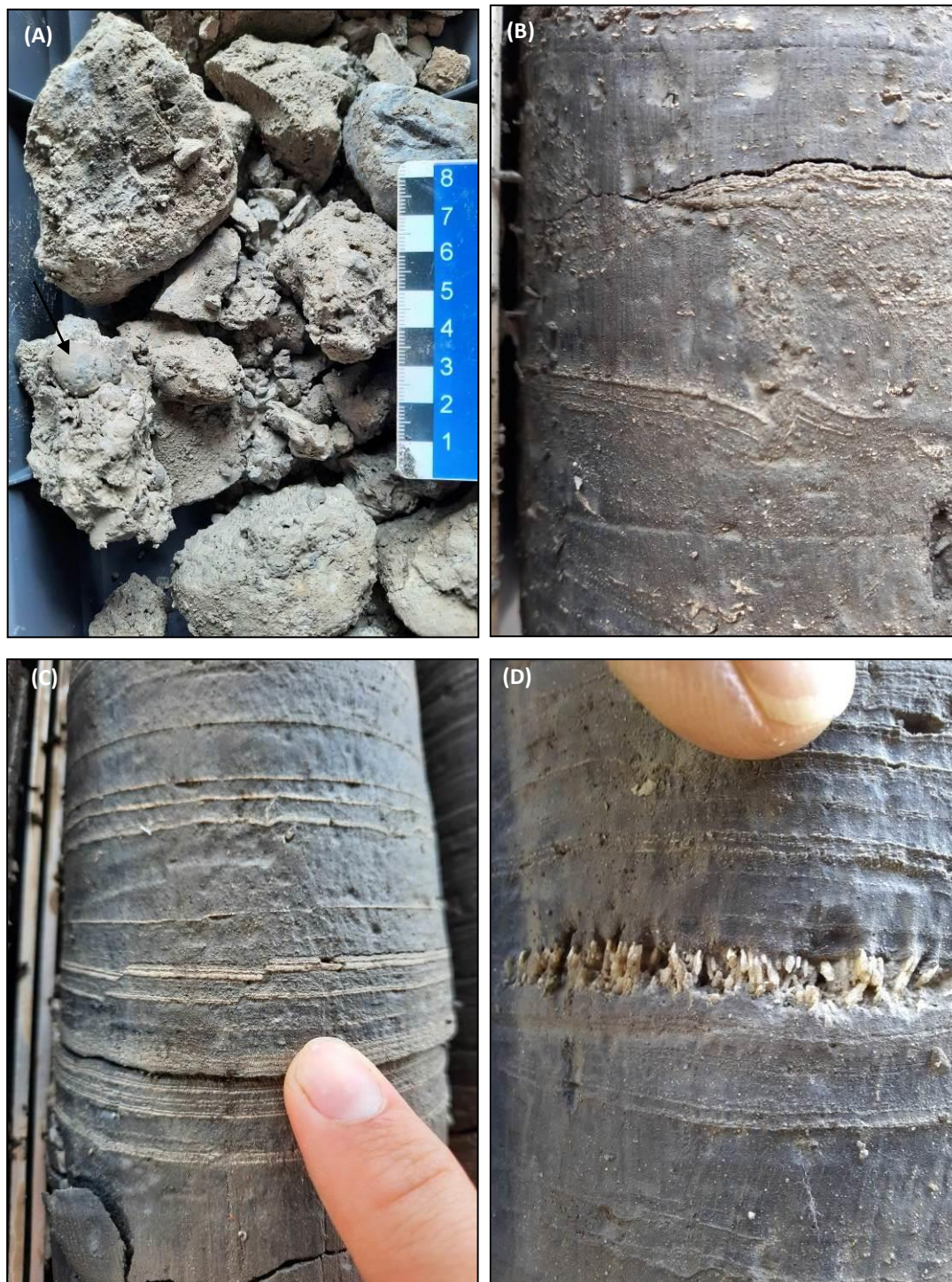
Fotografia 06 – (A) Calcarenito fossilífero (seta) intensamente fraturado (306,60m); (B) Estruturas sin -sedimentares (microlaminações e microdobra) em argilito calcífero com S_0 sublinhado por “linhas” de calcarenito e (C) Estruturas sin -sedimentares na forma de microfalhas (intervalo 321-327m), e; (D) Cavidade preenchida por cristais de calcita do tipo dente de cão” (322,70m).
