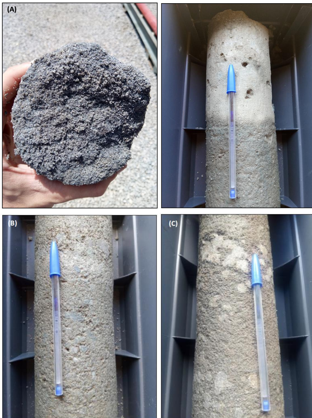
Fotografia 03 – Testemunhos pertencentes a Formação Poção: (A) Arenito cinza escuro, carbonático, friável ( 375,95m ), e; (B) Contato entre arenito cinza escuro com calcarenito bege ( 384,05m ); (C) Arenito conglomerático (Para-conglomerado) cinza claro, formado por grânulos de quartzo e litoclastos de rocha máfica ( 407,73m ); (D) Arenito conglomerático com coquina ( 415,35m ),
