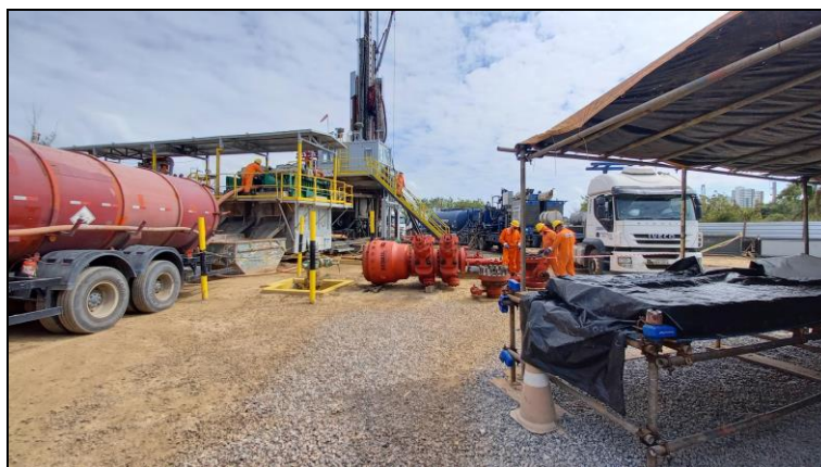
Fotografia 01 – (A) Inspeção das ferramentas de perfilagem antes das corridas: (B) Layout da Schlumberger para as perfilagens (destaque para o tanque onde foram efetuados os disparos de air-gun para análise VSP, e: (III) Inspeção e preparação do BOP ( Blow Out Preventer ) para instalação. Ao lado, unidade de cimentação utilizada para cimentar o poço.
