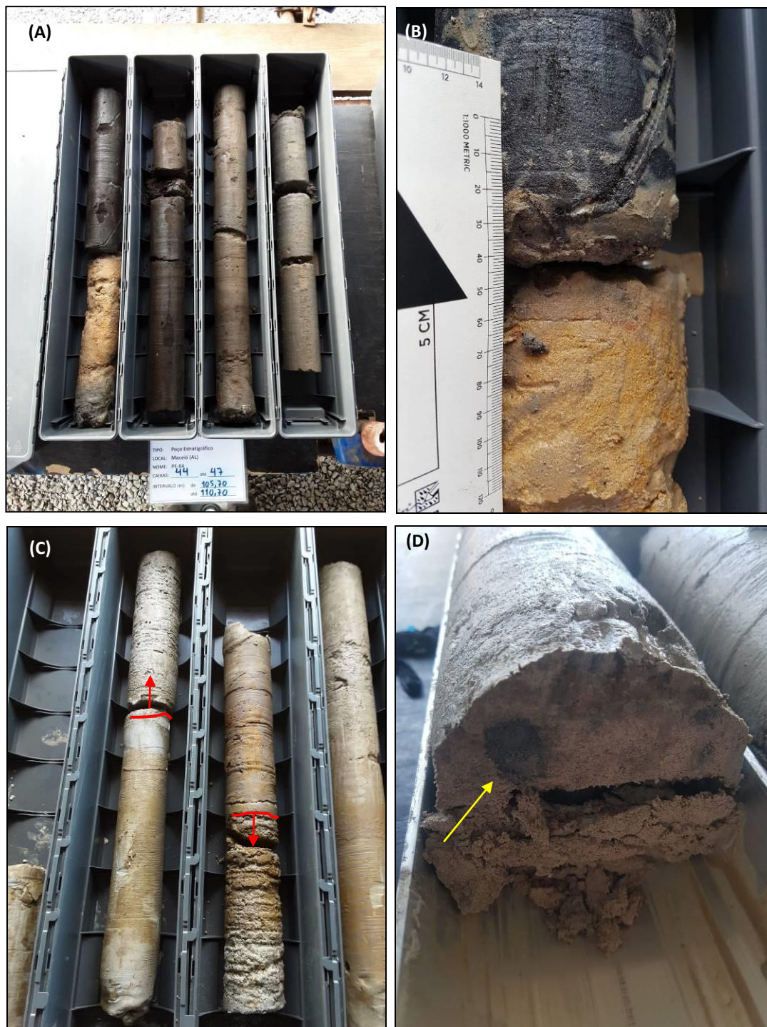
Fotografia 02 – (A) Zona de contato entre sedimentos arenosos da Fm Barreiras (amarelado) com sedimentos siltico arenosos da Fm Marituba (negro); (B) detalhe do contato da fotografia anterior, entre as formações Barreiras e Marituba; (C) Intervalo centimétrico de arenito conglomerático na Fm Marituba (setas em vermelho), e; (D) fragmentos de arenito negro (seta amarela) em meio a arenitos finos a médios na Fm Marituba (115,55m).
