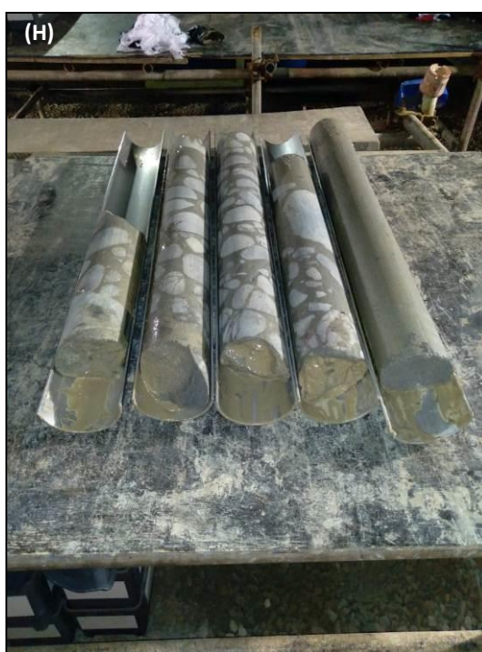
FOTOGRAFIA 06 – continuação...: (E) Ortoconglomerado típico (595,90m); (F) Detalhe dos clastos graníticos subarredondados (598,85m); (G) TEST 163 exibindo aspecto do conglomerado indo do íntegro ao fortemente fragmentado. Verifica-se o contraste de competência no pacote litológico, dificultando os ajustes na perfuração, e; (H) Intervalo entre 655,25m até 658,75m exibindo conglomerados polimíticos (topo) gradando a arenitos (base);
