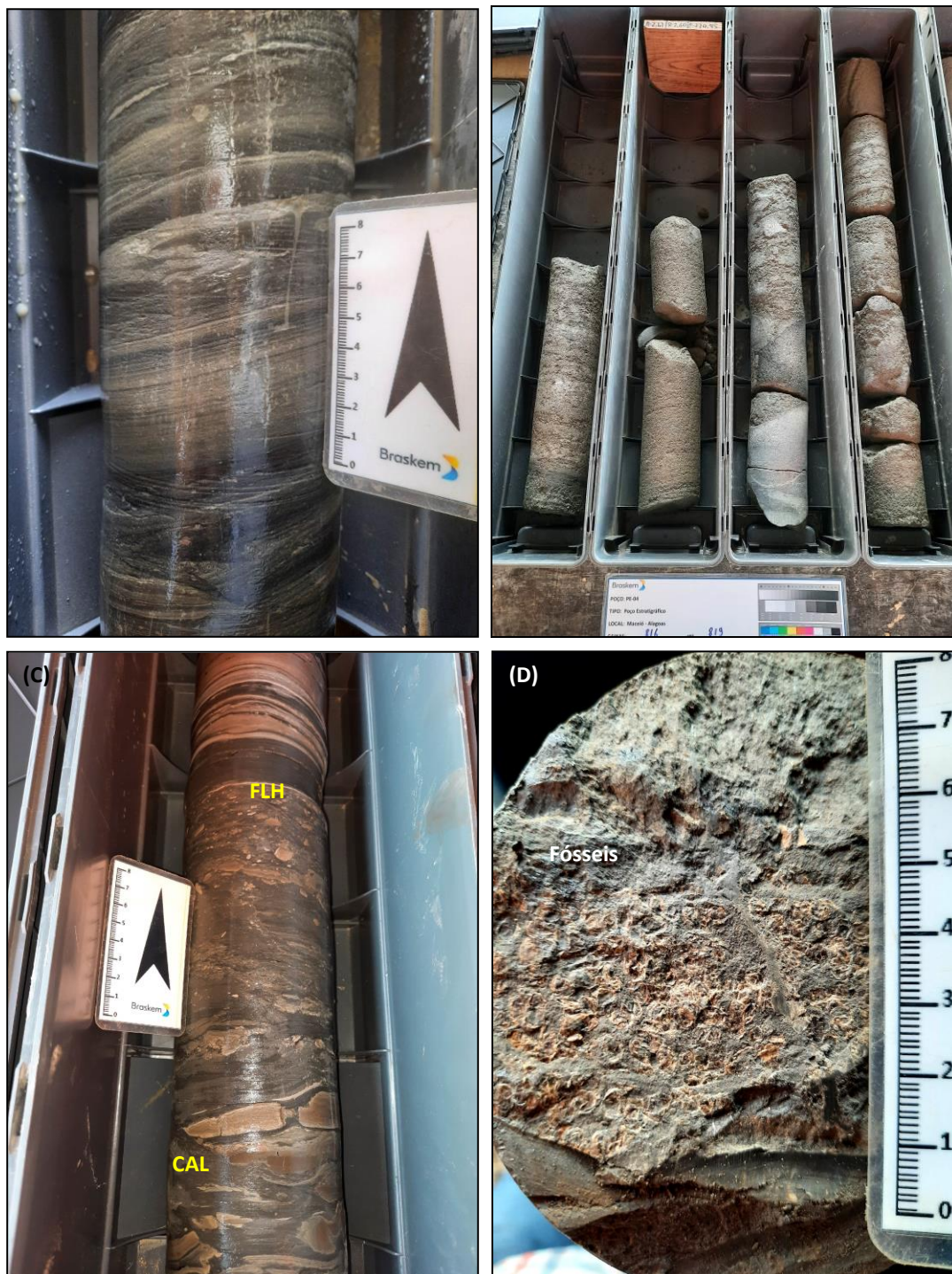
Fotografia 01 – (A) Testemunho típico do membro Tabuleiro dos Martins, exibindo S_0 marcante e penetrativo, com estruturas sin-sedimentares de slump ( 768,25m ); (B) Intervalo de 769,50m até 772,08m exibindo interdigitação de arenito conglomerático e conglomerado da Formação Poço; (C) Brecha sedimentar caracterizada por clastos de calcário ( CAL ) cimentados por folhelho ( FLH ) preto ( 812,20m ), e; (D) detalhe da ocorrência de fósseis em meio a camada de calcário ( 837,74m ).
