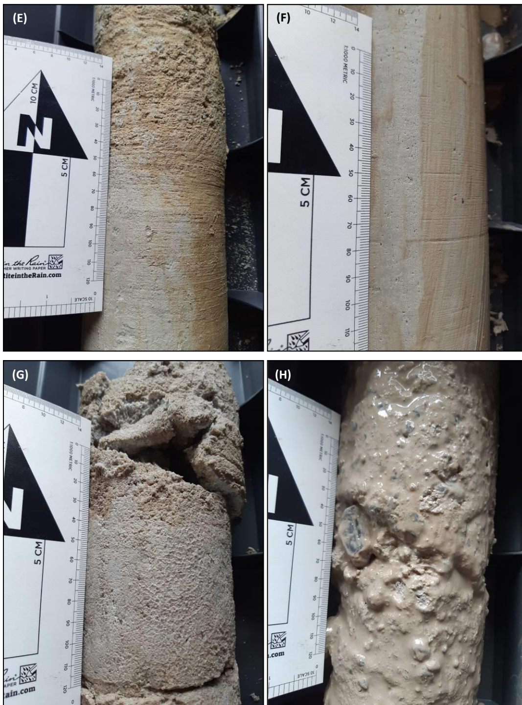
Fotografia 02 – (E) Zona de contato entre arenito fino e arenito grosso, conglomerático, centimétrico ( 137,60m ); (F) Argilito cinza claro de aspecto maciço ( 140,53m ); (G) Arenito inconsolidado, cinza claro, médio a grosso, mal selecionado ( 146,00m ), e; (H) Conglomerado/Brecha oligomítica, quartzosa, contendo seixos de quartzo de até 5,5cm em seu eixo maior ( 149,60m ).
