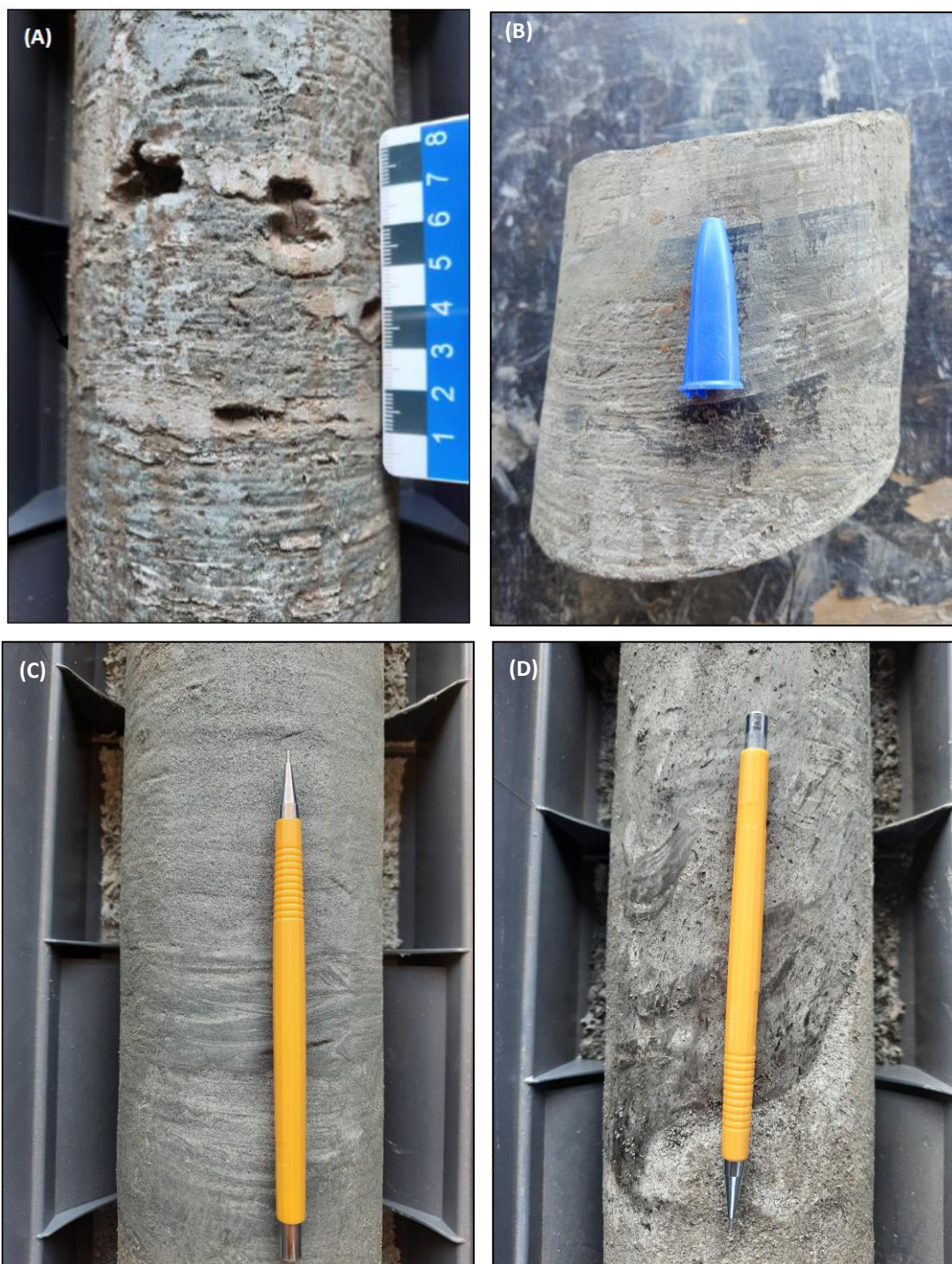
Fotografia 04 – Testemunhos pertencentes a Formação Poção: (A) Siltito cinza-esverdeado com intercalação de calcilutito (395,50m); (B) Intercalações de folhelho (cinza escuro) com calcilutito e calcarenitos (cinza claro), com S_0 marcante (444,50m); (C) Siltito com intercalação de arenitos exibindo estratificações cruzadas de pequeno porte (499,35m), e; (D) Intercalação de folhelho com arenito mostrando fragmentos de matéria orgânica (512,85m),
