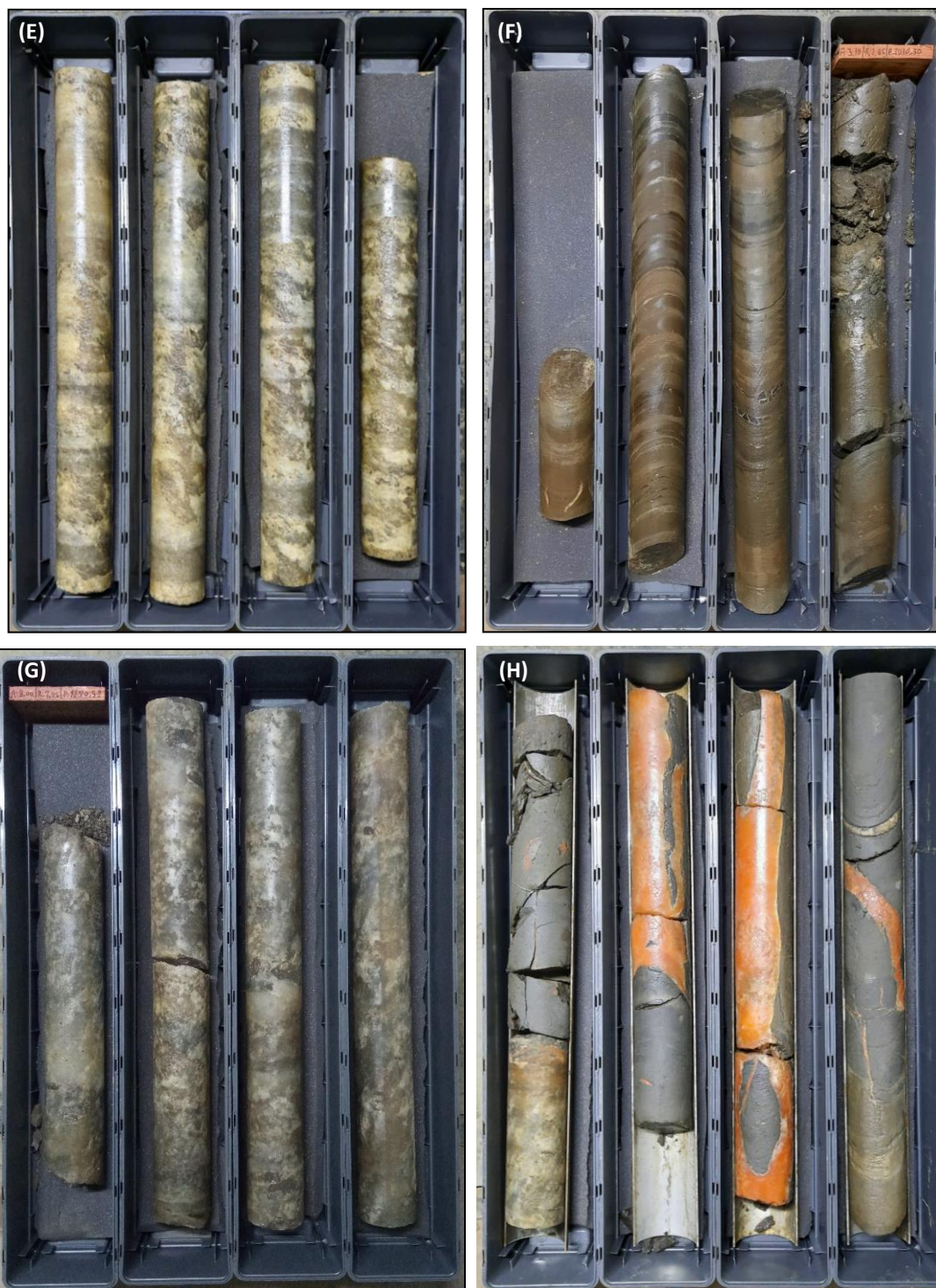
Fotografia 02 – (E) Intervalo de 997,27m até 1.000,68m exibindo camada de salgema com passagens impuras cinza-escuro (argila); (F) Intervalo de 1.007,20m até 1.010,30m exibindo folhelho preto ( S_0 = 45^\circ-55^\circ ), com intercalações cm de sal-gema cinza, níveis carbonáticos e arenito cinza a siltoso de matriz carbonática; (G) Intervalo de 1.189,97m até 1.193,25m exibindo sal-gema mosqueado, e; (H) Intervalo de 1.141,37m até 1.144,60m exibindo folhelho/argilito negro com fraturas preenchidas por sal-gema rosa a avermelhado, e:
