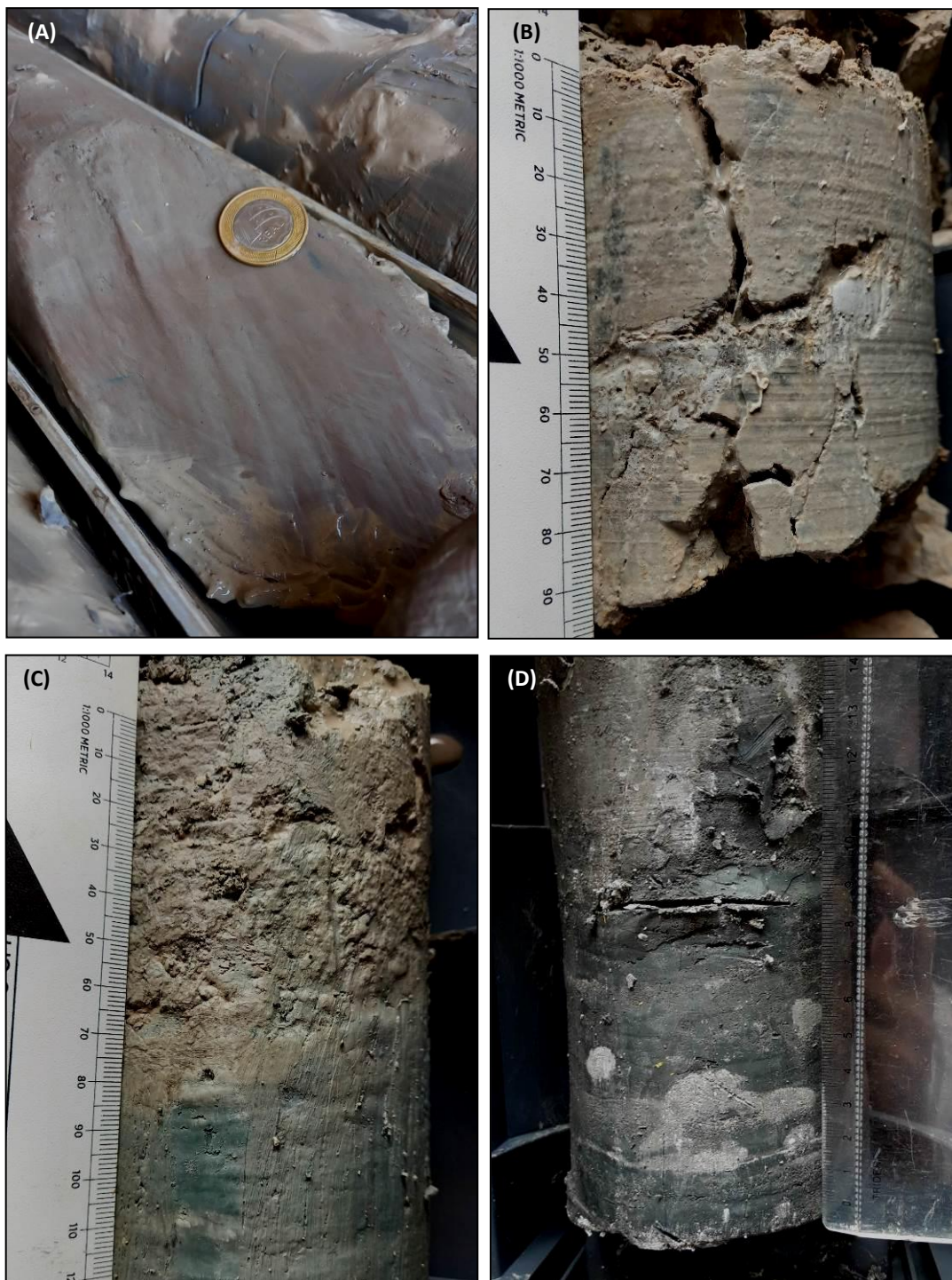
Fotografia 03 – (A) Plano de fratura com estriais em marga “chocolate” (168,00m); (B) Calcarenito intensamente fraturado (170,50m); (C) Contato calcilutito cinza escuro esverdeado e calcarenito cinza claro (177,47m), e; (D) Intercalação de calcilutito cinza esverdeado em meio a camada de calcarenito (188,92m).
