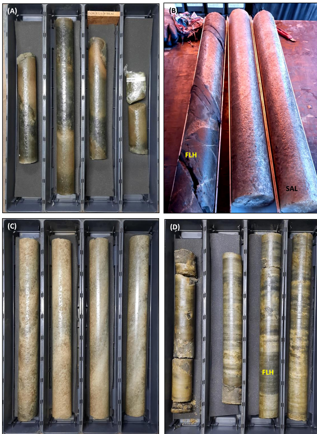
Fotografia 02 – (A) Intervalo de 913,60m até 916,44m exibindo o topo da camada de sal-gema nas cores cinza claro e escuro e amarelada; (B) Zona de contato entre “lente” de folhelho e argilito negro ( FLH ) em meio a camada de salgema ( SAL ) em 929,50m ; (C) Intervalo de 937,68m até 941,26m exibindo aspecto da camada de salgema com intercalações cinza-escuro; (D) Intervalo de 987,84m até 991,13m exibindo intercalações de folhelho (cinza-escuro) na camada de salgema.
