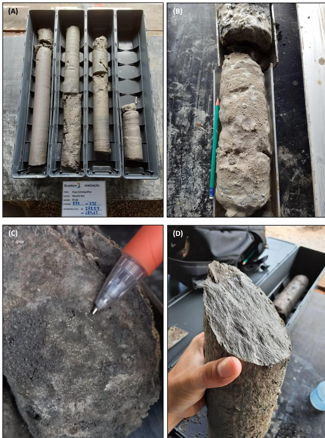
Fotografia 05 – (A) Intervalo 279,57m até 284,65m mostrando o aspecto inconsolidado dos intervalos arenosos; (B) Aspecto do arenito/areia inconsolidado (260,66m); (C) Nível sulfetado em meio a calcaneritos (303,40m), e; (D) Manobra TEST 91 (intervalo de 297,40m até 303,40m), mostrando testemunho com passagens de arenitos e calcarenitos, consolidadas a semi-consolidadas.
