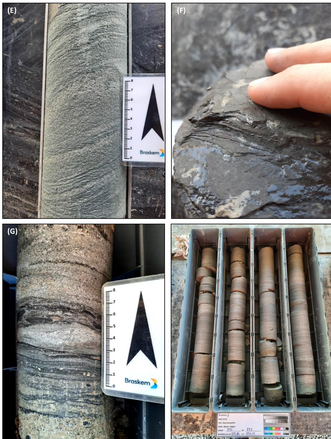
Fotografia 04 – continuação... (E) Intercalação de arenito, folhelho, argilito e calcarenito com acamamento S_0=65^\circ (553,00m); (F) Detalhe do Folhelho preto, laminado (571,87m); (G) detalhe da intercalação de folhelho em arenito conglomerático da fotografia 1C -(721,50m), e; (H) Intervalo entre 733,80m até 737,51m exibindo intercalação folhelhos, argilitos, arenito e calcarenitos
