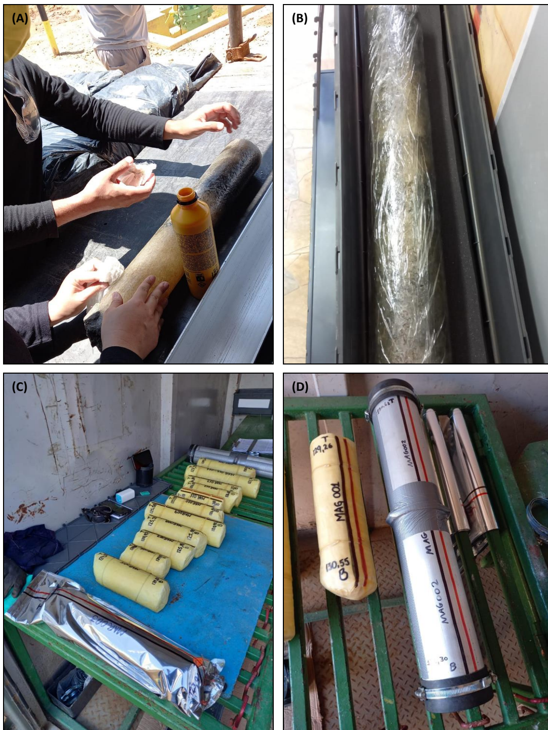
Fotografia 03 – (A) Etapa de preparação dos testemunhos de salgema envolvendo limpeza do fluido de perfuração e aplicação da vaselina; (B) Detalhe do testemunho embalado em plástico filme; (C) amostra parafinadas e embaladas com sacola de alumínio selada, e; (D) Detalhe das amostras preparadas com cera e embaladas com tubo de alumínio.
