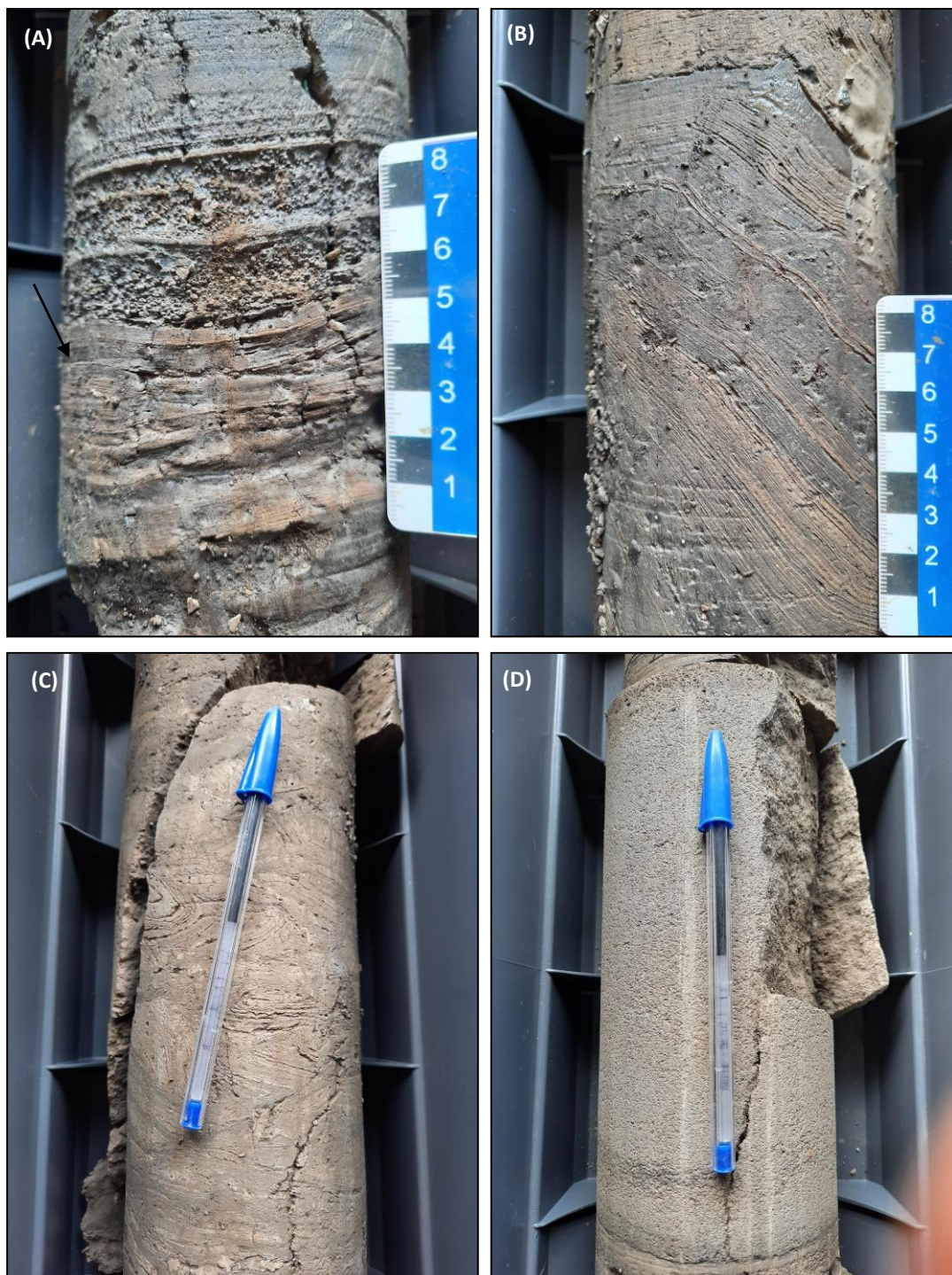
Fotografia 02 – Testemunhos pertencentes a Formação Muribeca (membro Ibura) : (A) Calcário laminado com feições de dissolução ( 336,44m ); (B) Calcilutito laminado com níveis milimétricos carbonáticos marcando o S0, com inclinação de 42° em relação ao eixo do testemunho ( 343,99m ); (C) Plano de fratura em calcilutito exibindo feições de slump micro dobrado ( 350,15m ), e; (D) Calcarenito maciço ( 354,50m ).
