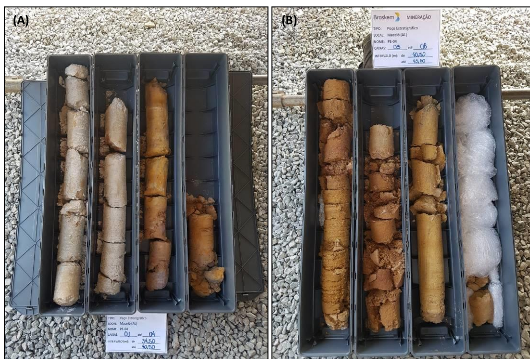
Fotografia 01 – (A) Registro fotográfico padrão dos testemunhos prontos para armazenamento, após descrição geológica (caixas e profundidade indicada) e (B) Aspecto frágil, inconsolidado, dos sedimentos constituintes da Formação Barreiras.
